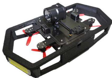
管路等調査点検用ドローン AirSlider®
